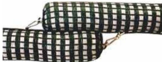
**FAYENCIT®-Ölsperren** sind auf *fließenden und stehenden Gewässern einsetzbar*. Durch eine keilförmige Ausbringung wird eine wirkungsvolle Ölabspernung erreicht. Somit kann an leicht zugänglichen Stellen des Einsatzortes das an der Wasseroberfläche schwimmende Öl gut abgesaugt werden. FAYENCIT®-Ölsperren binden bei ordnungsgemäßer Handhabung die entsprechende aufgesaugte Ölmenge und sind nach erfolgtem Einsatz in Sondermülldeponien oder in Verbrennungsanlagen zu entsorgen.
